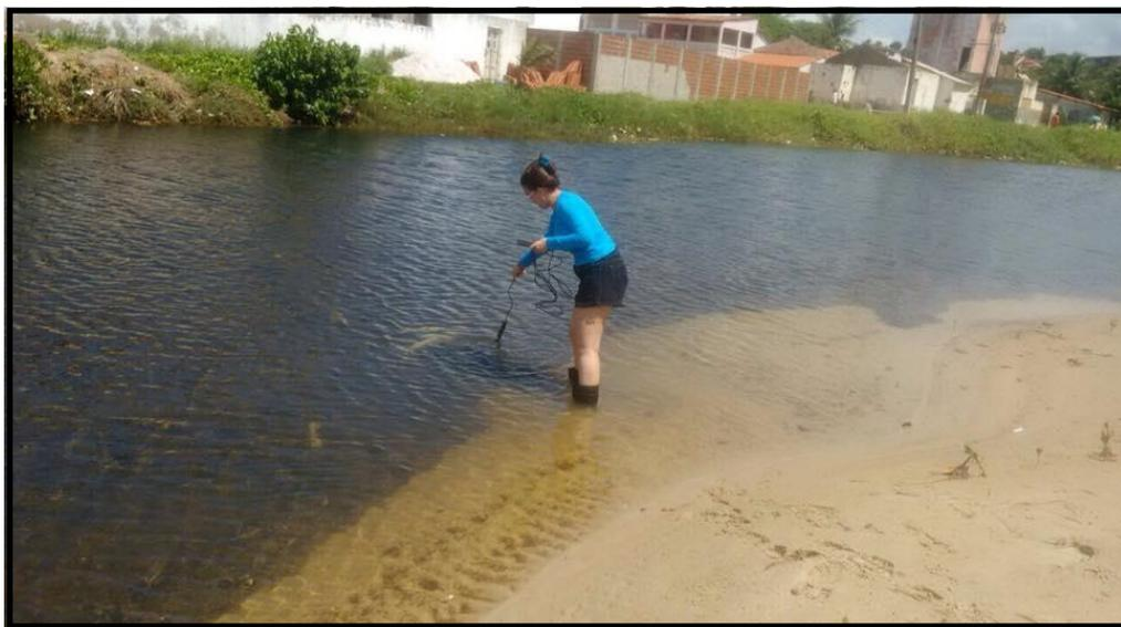
**Figura 9.** Medição do Oxigênio e Temperatura na Laguna costeira
