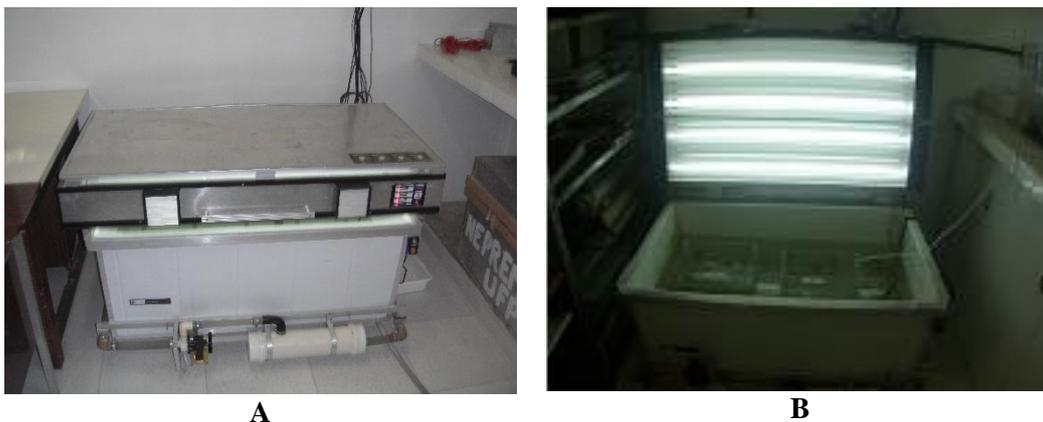
Figura 6- Câmara incubadora microprocessada (A) contendo os aquários (B) utilizados nos experimentos de indução do branqueamento por elevação da temperatura, do coral *S. stellata* coletados nos recifes do Cabo Branco, João Pessoa – PB.
