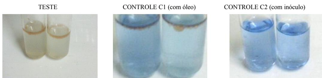
**FIGURA 7:** Testes de degradação de óleo diesel, por bactérias isoladas do solo rizosférico de plantas *Calotropia procera* (linhagem P1R21), realizado em tubos de ensaio.
